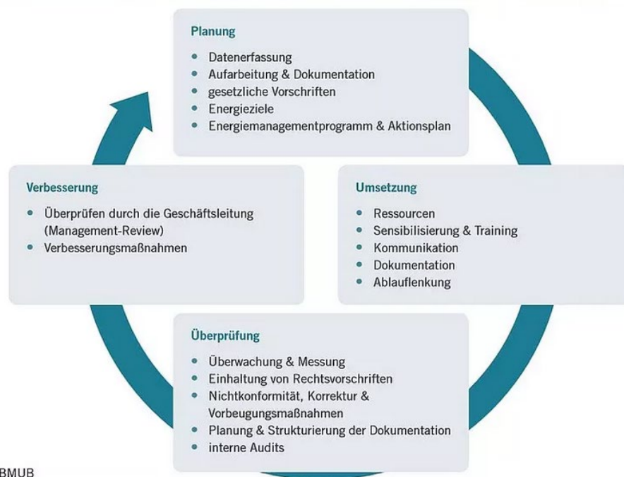
Abbildung 1: Ablauf des Energiemanagements 7 nach ISO 50001 – Planen – Umsetzen – Überprüfen – Verbessern
